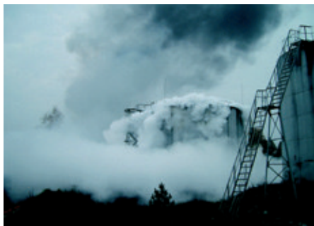
Рис. 2. Кадры испытаний АУГП на РВС-2000
